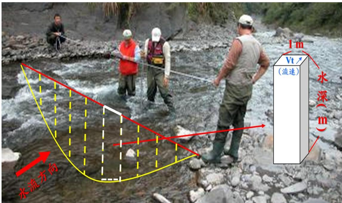
圖 3 穿越線測量方式示意圖
